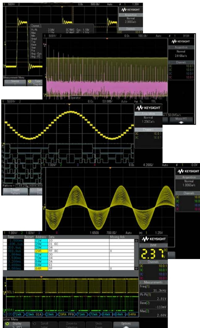
на экране и декодирования данных. Преимущества становятся особенно очевидны при использовании глубокой памяти, что часто требуется для захвата нескольких пакетных сигналов последовательной шины. Аппаратное ускорение декодирования протокола облегчает работу с осциллографом и, что более важно, повышает вероятность захвата редких ошибок при последовательной передаче данных.
